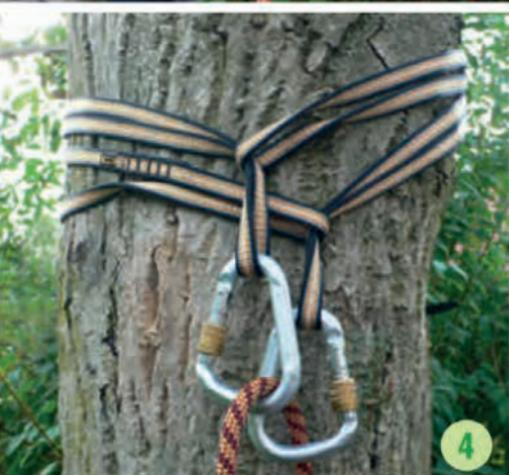
1. Point d'ancrage avec corde de secours
